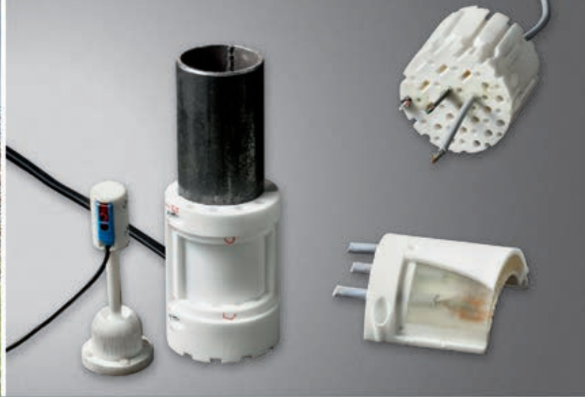
Verschiedene lasergesinterte Kunststoffteile als Hilfsmittel für Betriebsmessungen. Laser-sintered plastic parts as tools for operational measurement.
