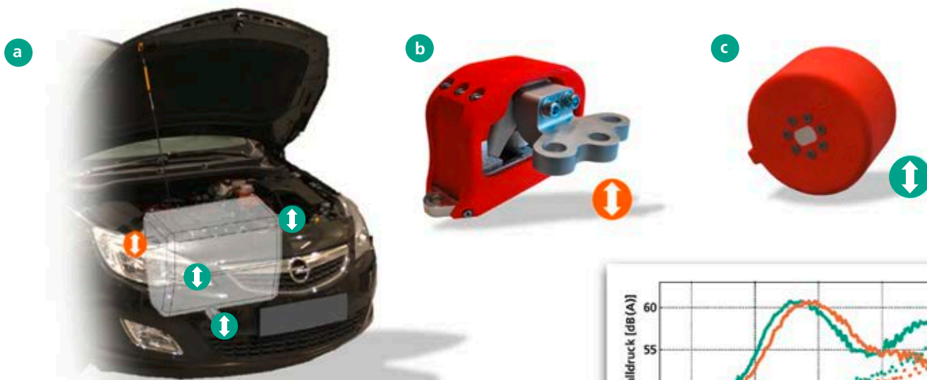
Abb. 2: a) Positionen der aktiven Komponenten im Motorraum; b) hybrid aktives Motorlager; c) elektrodynamischer Inertialmassenaktor. Fig. 2: a) positions of the active components; b) hybrid active engine mount; c) electrodynamic inertial mass actuator.
