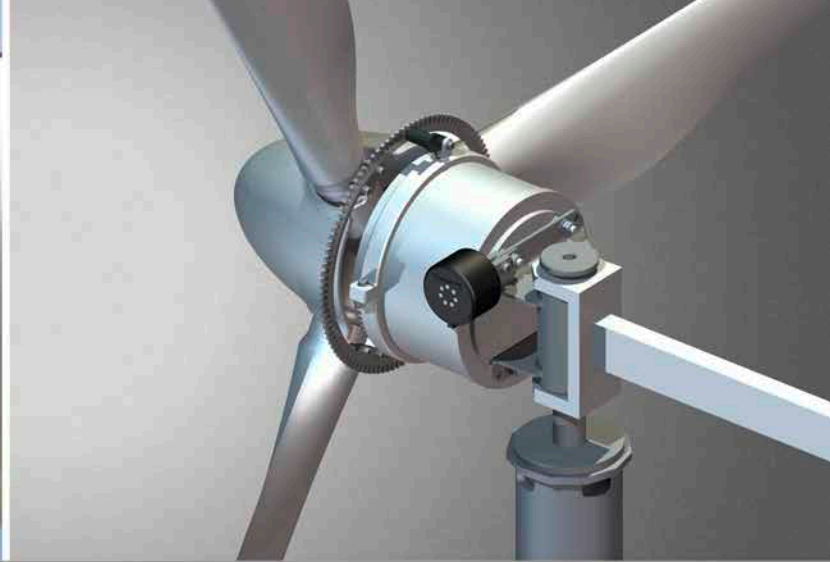
Versuchsanlage mit aktivem Zusatzsystem im CAD. Small wind turbine with active system in CAD.
