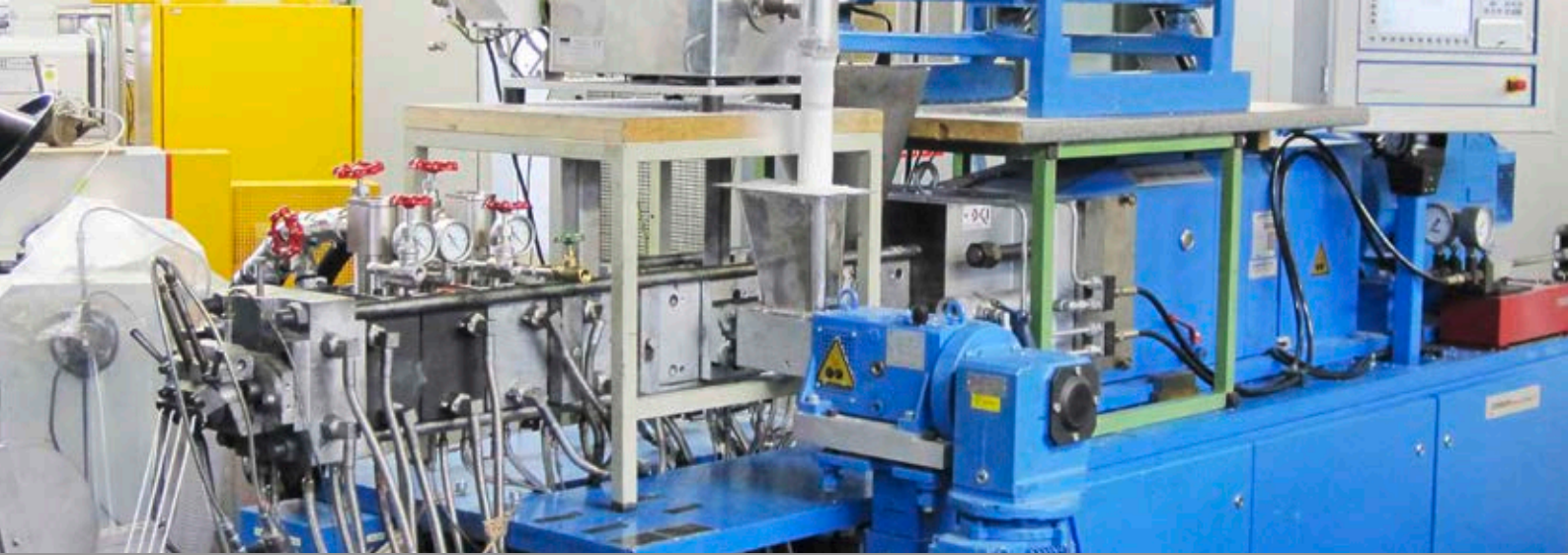
Hochleistungsdoppelschneckenextruder ZSK32MC mit modularer Entgasungseinheit im Fraunhofer LBF. High-Speed-Twinscrew-Extruder with adapted modular degassing unit at Fraunhofer LBF.
