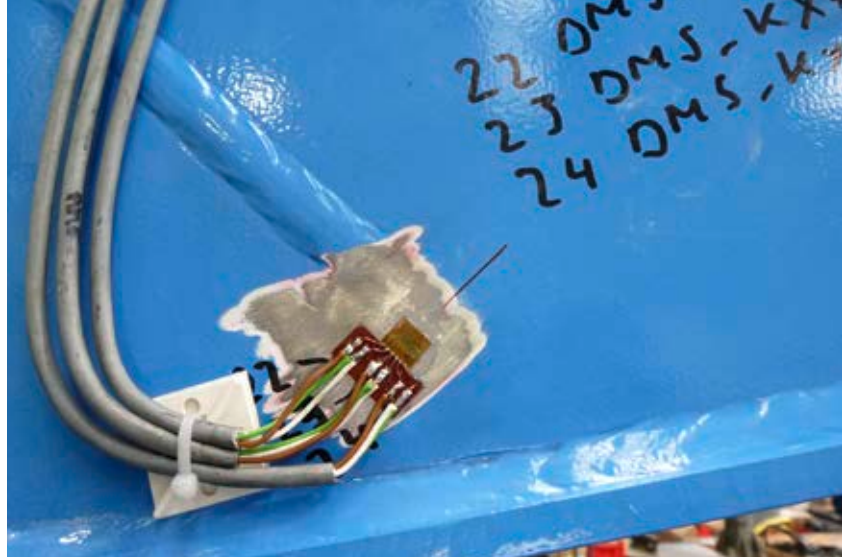
Dehnungsmessstreifen an hochbelasteten Stellen der Maschine. Wire strain gauges on highly-stressed areas of the material handler.
