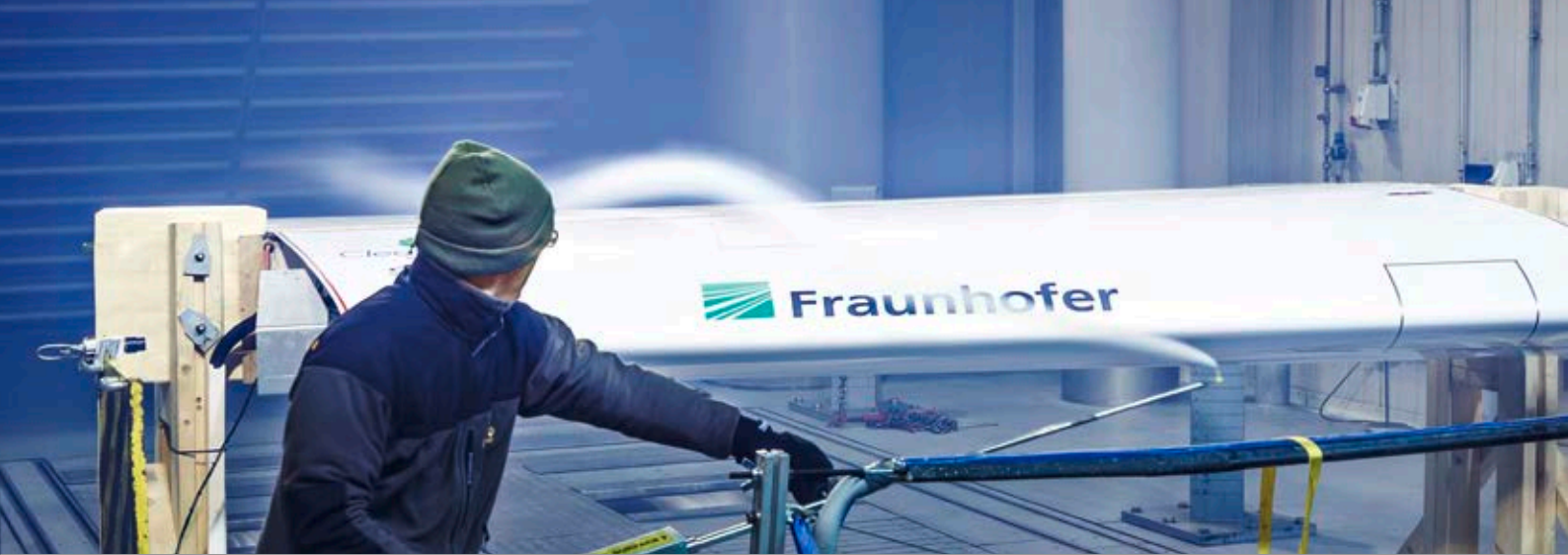
Einsatz der Rauchlanze im Klimawindkanal. Use of a fume lance at the climated wind chanel.
