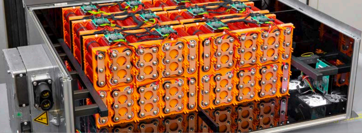
Wissenschaftler des Fraunhofer LBF haben ein 10 kWh Batteriesystem mit eigensicheren LFP-Zellen sowie integriertem Batterie-Managementsystem entwickelt und aufgebaut. Es dient unter anderem für die Inbetriebnahme des neuen Batterietesters in Darmstadt. Scientists of the Fraunhofer LBF have developed and constructed a 10 kWh battery system with intrinsically safe LFP cells and an integrated battery management system. Among other things, it will be used for commissioning the new battery tester in Darmstadt.
